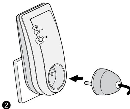
**2** Anschließend den Stecker des zu steuernden Elektrogeräts an den Empfänger anschließen.
