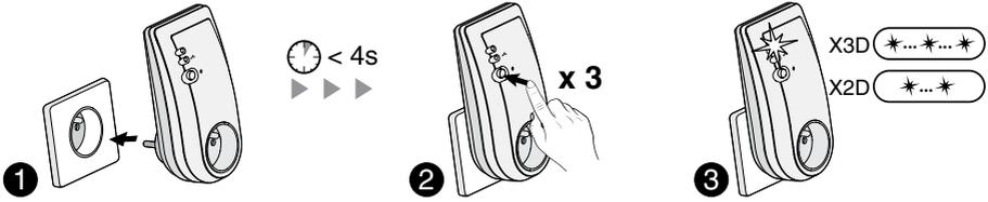
Bei Spannungszuschaltung (1) müssen Sie innerhalb 4 Sekunden 3 Mal auf die Taste (2) drücken. Die Kontrollleuchte blinkt (3): 2 Mal für X2D, 3 Mal für X3D.
