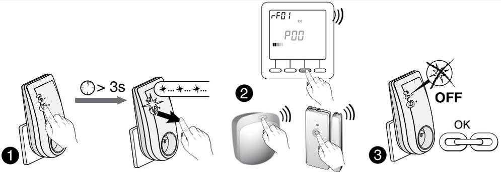
Drücken Sie 3 Sekunden lang auf die Taste des Empfängers, bis dessen Kontrollleuchte blinkt. Lassen Sie die Taste los.
