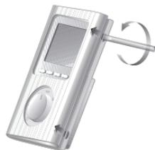
• Entnehmen Sie das Thermostat durch Ausdrehen der Klemmschraube ① (unverlierbare Schraube) dem Sockel.
