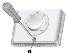
• Befestigen Sie den Sockel ausschließlich mit einer Unterputzdose (Achsabstand: 60 mm).
