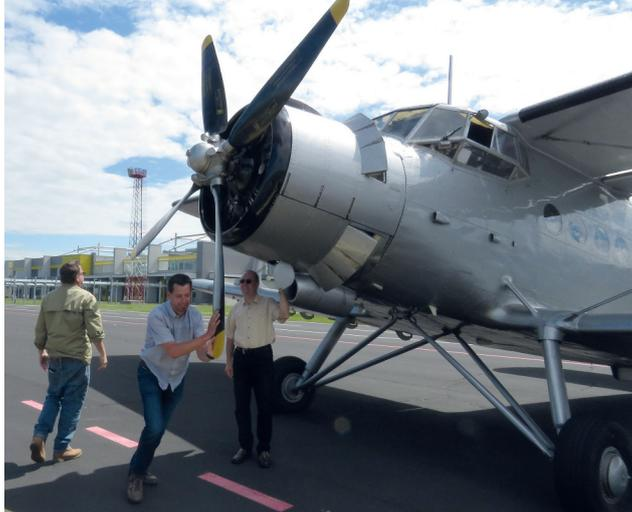
*Vor jedem Abflug wird der Propeller gedreht, um überschüssiges Öl abzulassen. Andere arbeiten und Oliver Karall? Der hält den Auffangbehälter, damit die Umwelt nicht verschmutzt wird....*
